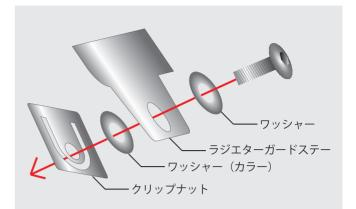
3.ガード下側ステーを付属のクリップナットと ボルト、ナットを用いてラジエター本体 と固定します。
