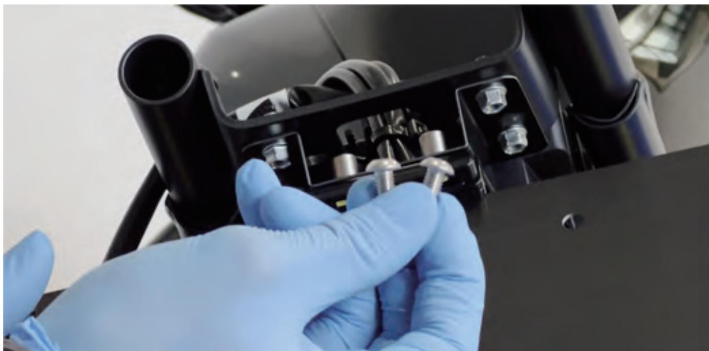
付属のボルト Aを使用してフェンダーレスKITを固定します
